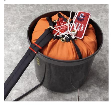
6) REMOVE THE TRANSPORT WHITE ROPE COMPLETELY!!!
